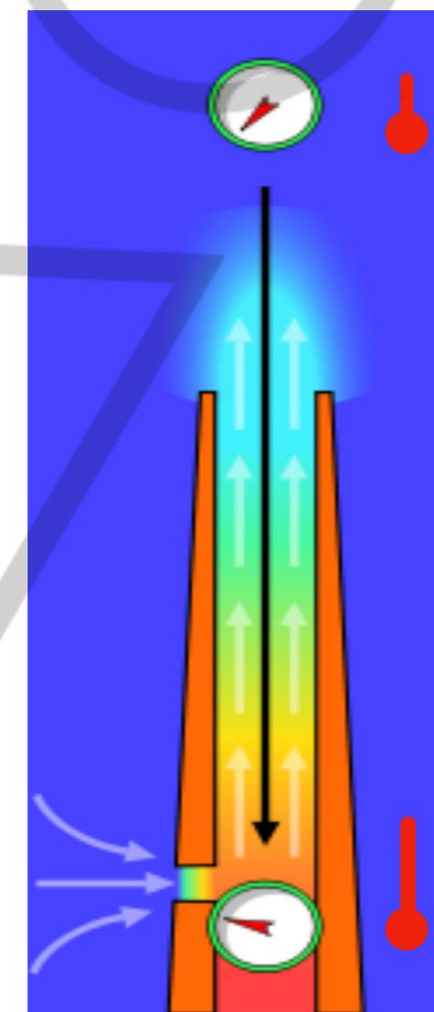
Il surriscaldamento dell'aria comporta la dilatazione del gas e conseguentemente riduzione del peso dell'aria che ne induce il movimento verso l'alto. Viceversa il suo raffreddamento provoca il fenomeno inverso
